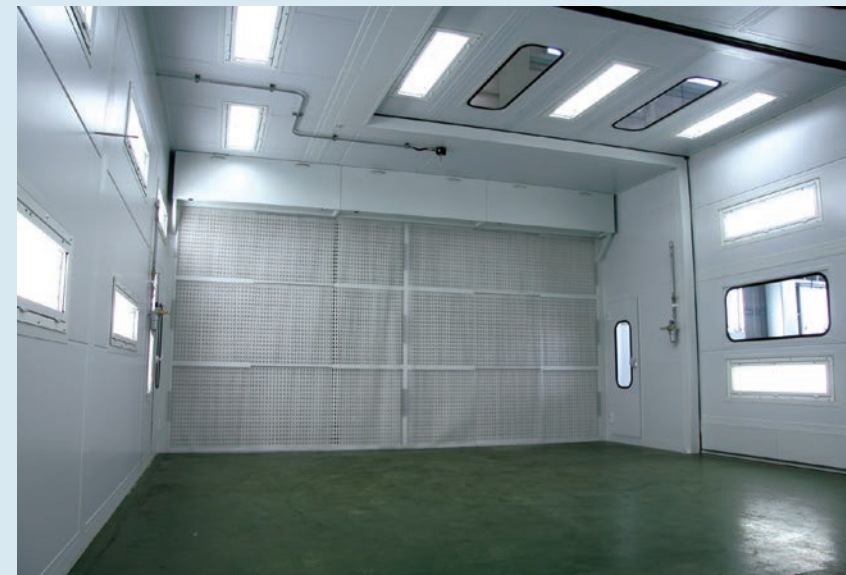
▲塗装ブース内排気側
